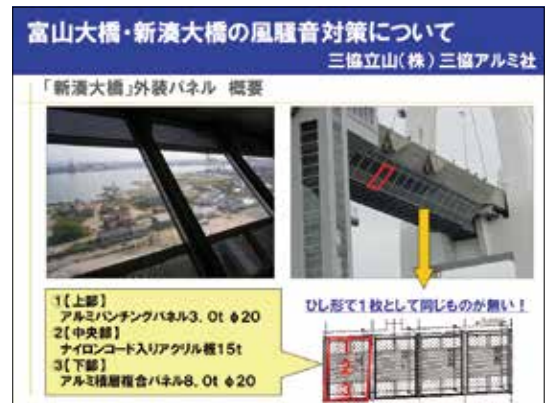
新湊大橋 外装パネル
