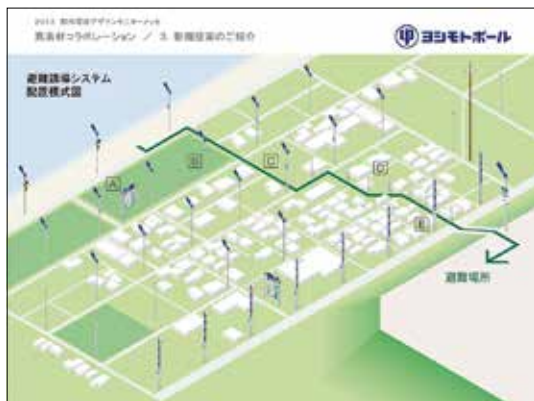
図9 避難誘導システム配置模式図
