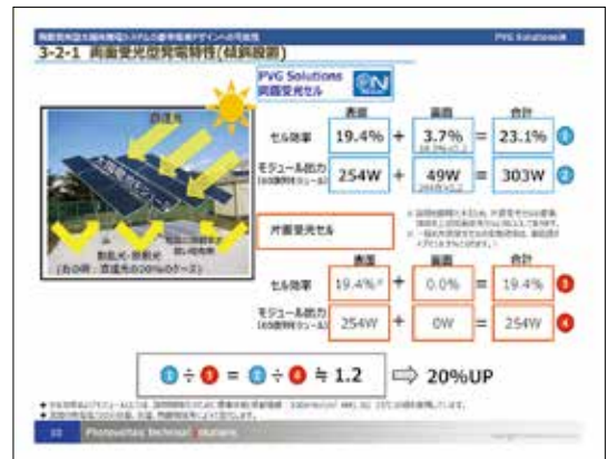
図5 両面受光型発電特性（傾斜設置）
