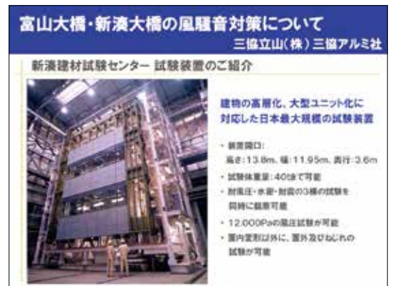
新湊建材試験センター大型試験装置
