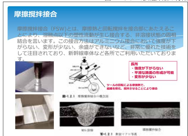
図3 摩擦攪拌接合
