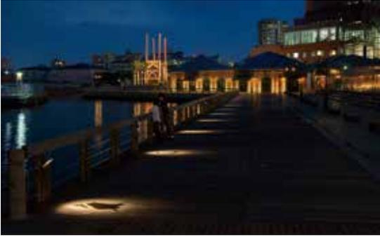
暗すぎる既存足元灯の外観は残し、内部にパワーLEDとレンズおよび影絵マスクを装着しリユース。大掛かりな費用をかけず、そぞろ歩きの喜びのあるデッキ空間へと再生した。手前遠方の港湾中心部からの視認性を高めるため、煉瓦倉庫は地中からLEDパッドライトでライトアップし、そのシルエットを浮かび上がらせた。
